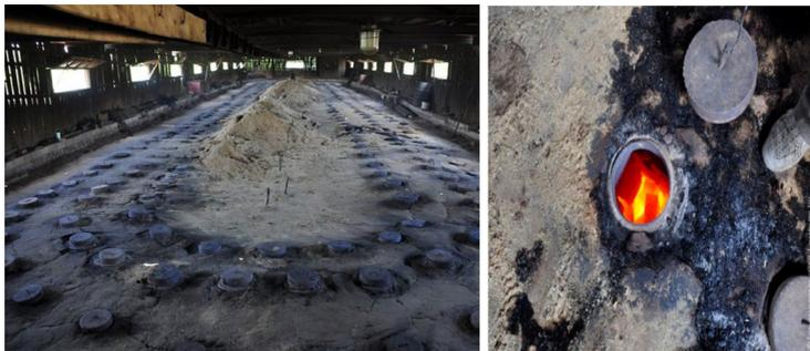
Рис. 23. Общий вид Гофмановской печи (слева) и отверстие для загрузки опилок (справа)
